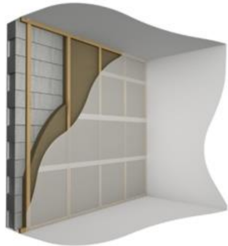
Figure 5-2 : Pose de la membrane pare-vapeur de manière étanche sur l'ossature bois et contre les panneaux de Gramitherm
