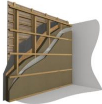
Figure 6-5 : Pose de la seconde couche de Gramitherm (respect de la règle dite des 3/4-1/4)
