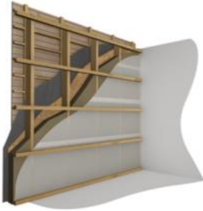
Figure 6-4-2 : Pose du lattage pour la seconde couche de Gramitherm
