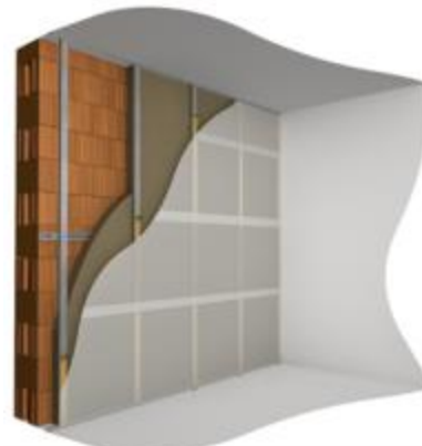
Figure 3-4 : Pose de la membrane pare-vapeur de manière étanche sur l'ossature métallique et contre les panneaux Gramitherm
