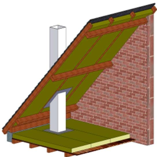
Un coffrage doit être réalisé avec des plaques de plâtre ou en bois d'une hauteur minimum de 20 % au-dessus de la hauteur de l'isolant. La distance de sécurité entre le conduit de fumée et l'isolant dépend du type de conduit ; cette distance doit être conforme à la norme NF DTU 24.1 P1 et au e-cahier du CSTB 3816.
