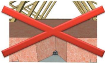
L'isolant ne doit jamais être mis en contact direct avec les dispositifs d'éclairage encastrés (fig. 3).
