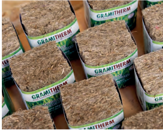
Door gras, jute en polyestervezels samen te drukken ontstaat een stevig isolatiepaneel.
